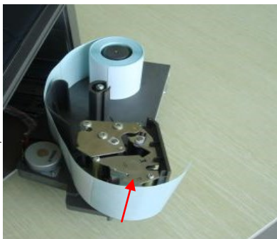
(3) Αφαιρέστε τις πρώτες ετικέτες του ρολού.
