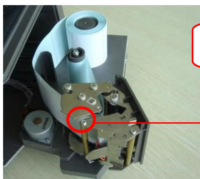
(5) Τυλίξτε το ρολό ετικετών έως ότου τεντώσει η ταινία και στην συνέχεια κλείστε την μονάδα εκτύπωσης.
