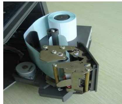
(4) Τοποθετήστε το ρολό ετικετών στον μηχανισμό τύλιξης.
